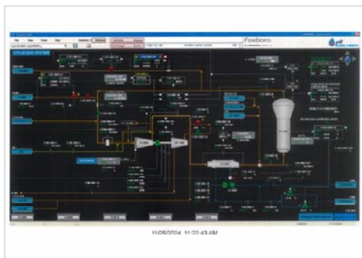
รูปที่ 63 หน้าจอระบบ DCS ควบคุมอุณหภูมิ ในถังเกิดปฏิกิริยา
